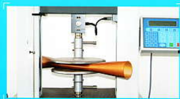
Fig. 1 Tubo sottoposto ad una forte sollecitazione esterna secondo UNI EN ISO 9969
