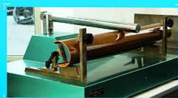
Fig. 2 Prova della scala secondo UNI 8649
